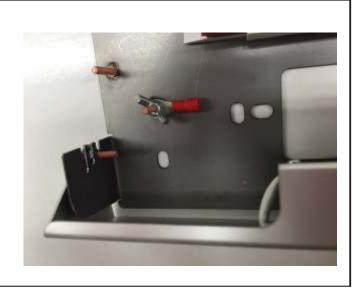
POSSIBILITA DI INCLINAZIONE DEL PRODOTTO RISPETTO ALLA PARETE A 0°, 10° E 20° A SECONDA DELL'ASOLA PREDISPOSTA SVITANDO E AVVITANDO L'APPOSITA PIASTRA ESTETICA TRAMITE I DADI AD ALETTE FORNITI
